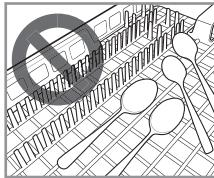
Los separadores de la cesta para cubiertos mantienen los utensilios separados para evitar daños y mejorar los resultados de lavado.
