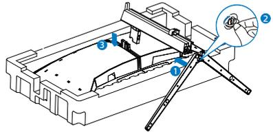
3. Después de unir la base, alce el monitor con las dos manos mientras sujeta el monitor con poliestireno. Ahora puede sacar el poliestireno. Cuando saque el poliestireno no comprima el panel para evitar romperlo.
