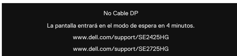
Figura 24. Mensaje de advertencia: No hay cable DP conectado
